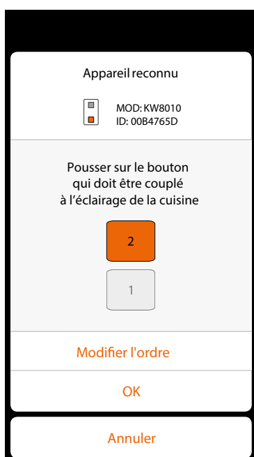
Configuration d'un point lumineux via l'App Digital Controls.
