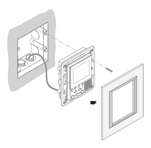
Une fois tous les branchements réalisés, fixer le Axolute Video Display au boîtier d'encastrement en veillant à disposer les fils de telle sorte qu'ils ne soient pas endommagés. Terminer l'installation en montant la plaque dans l'esthétique voulue.
