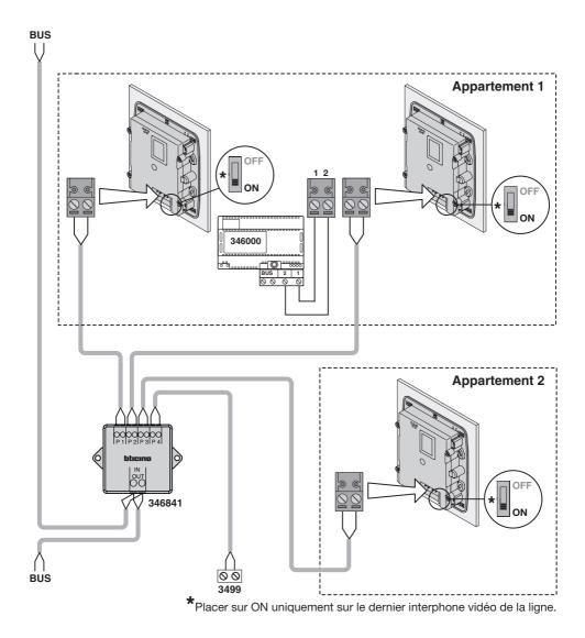
**Note:** pour installer des interphones vidéo en allumage simultané dans l'appartement, il est nécessaire de prévoir une sortie du dérivateur d'étage pour chaque PI de l'appartement.
