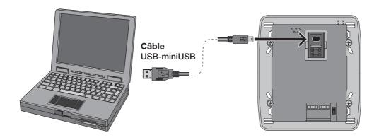
Pour que la communication soit assurée, le Axolute Video Display doit être connecté au BUS et alimenté.
