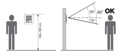
Note: pour permettre aux porteurs de handicap de l'utiliser, le Axolute Video Display doit être installé à une hauteur comprise entre 125 et 130 cm.
