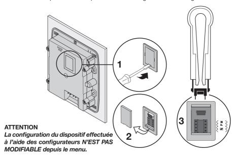
Sur le dispositif sont présents quatre logements de configuration.
