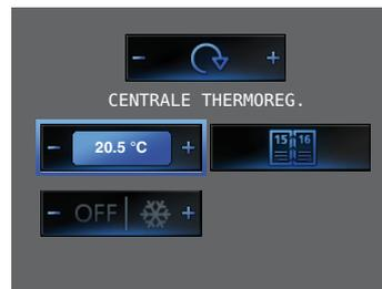
Il est possible de sélectionner la modalité manuelle et de régler la température à l'aide des touches - +
